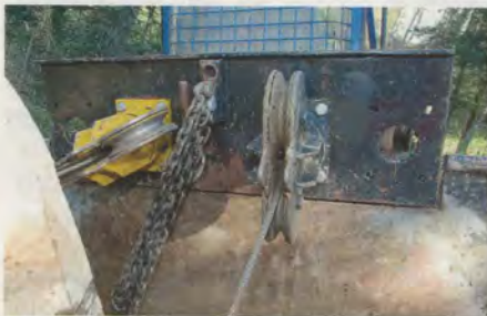
Depuis sa mise en service, le tracteur n'a subi qu'une transformation: les poulies de sortie ont été déplacées vers le centre pour améliorer la stabilité du tracteur.
