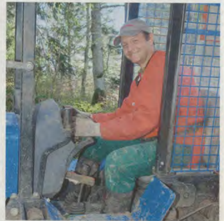
Le poste de conduite est d'origine. Des marchepieds renforcés facilitent l'accès et couvrent le passage du câble. Ici, Martial Oppliger.
